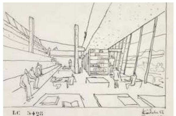
/ CROQUIS, LE CORBUSIER, 1956. SUR CES CROQUIS APPARAISSENT ENCORE LES POTEAUX-ORTEURS, SUPPRIMÉS ENSUITE GRÂCE À LA CRÉATION DE LA TOITURE SUR CÂBLES.
